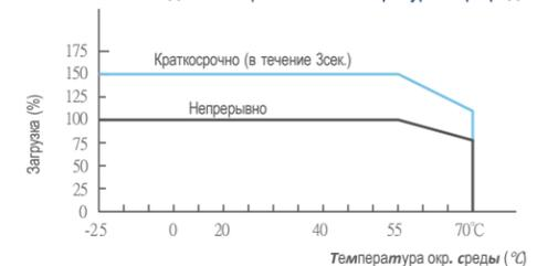
Техническая спецификация (Источники питания серии SLD мощностью 240Вт для монтажа на Din-рейку)
