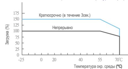
Техническая спецификация (Источники питания серии SLD мощностью 120Вт для монтажа на Din-рейку)
